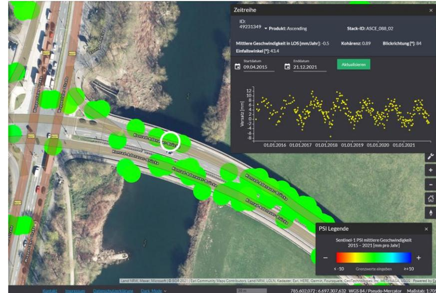
Abb.12: Saisonales Deformationsmuster an einer Brücke in Essen.
